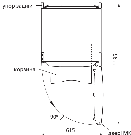
Рисунок 2 — Холодильник (вигляд зверху)
